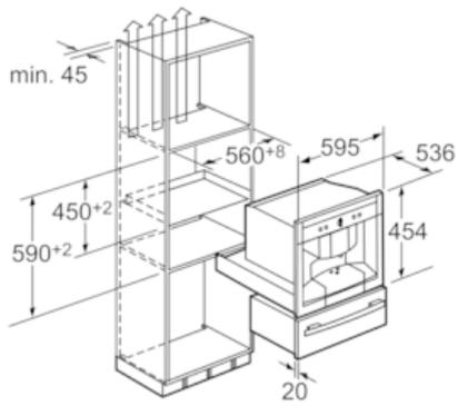
Der Espressovollautomat kann über einer Wärmeschublade eingebaut werden. Ein Zwischenboden ist nicht erforderlich. Maße in mm
