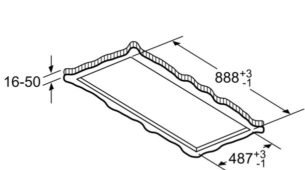
Nicht direkt in die Gipskartonplatte oder ähnliche Leichtbaustoffe der abgehängten Decke montieren. Geeignetes Untergerüst erforderlich, das fest in der Betondecke fixiert ist.
