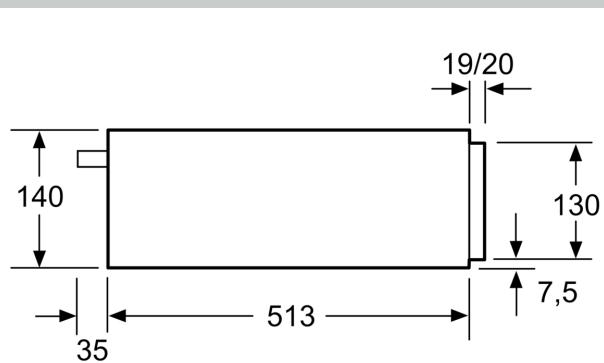
Über eine Wärmeschublade können Kompakt-Backöfen mit einer Gerätehöhe von 455 mm eingebaut werden.
