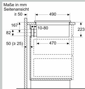
Bei der Installation direkt an einer nicht isolierten Außenwand ( $\mu \geq 0.5 \text{ W/m}^2 \text{ °C}$ ) empfehlen wir die Verwendung von Konfigurationen mit teilweise oder vollständig kanalisierten Rezirkulation.
