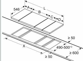
Bei der Side-by-Side-Montage von zwei oder mehreren Elementen sind ein oder mehrere Montagesets erforderlich (2 Elemente = 1 Montageset; 3 Elemente = 2 Montagesets usw.).
