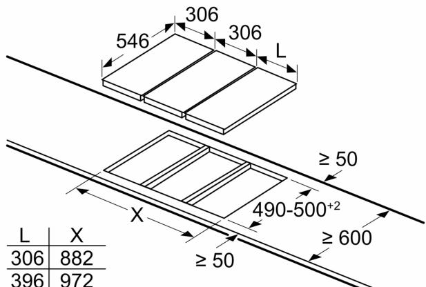
Bei der Montage von zwei oder mehreren Domino-Elementen sind ein oder mehrere Montagesets erforderlich (2 Elemente = 1 Montageset; 3 Elemente = 2 Montagesets usw.).
