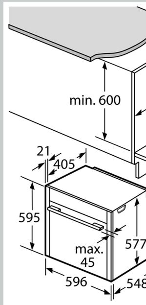
Wird das Gerät unter eingebaut, muss folgende Stärke (ggf. inkl. Unterbecken) beachtet werden.
