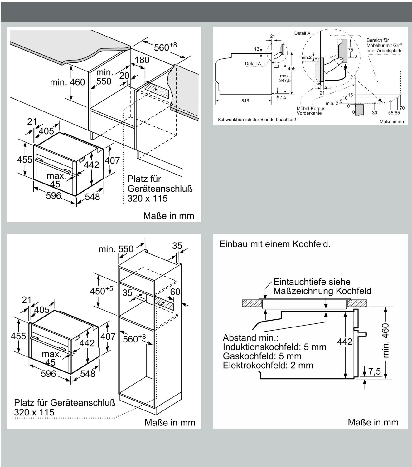
Wird das Kompaktgerät unter einem Kochfeld eingebaut, muss folgende Arbeitsplattenstärke (ggf. inkl. Unterkonstruktion) beachtet werden.
