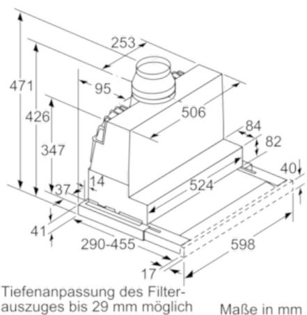
Tiefenanpassung des Filterauszuges bis 29 mm möglich
