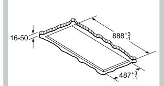
Nicht direkt in die Gipskartonplatte oder ähnliche Leichtbaustoffe der abgehängten Decke montieren. Geeignetes Untergerüst erforderlich, das fest in der Betondecke fixiert ist.
