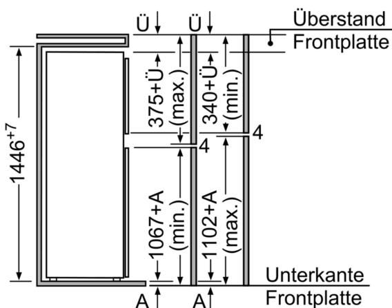
Die angegebenen Möbeltürmaße gelten für eine Türfuge von 4 mm. Bei Verwendung einer anderen Fugenbreite (max. 14 mm) müssen die Maße angepasst werden.
