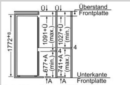
Bei größeren Maßen (1780 - 1790) muss an der Nischendecke eine Distanzleiste vorgesehen werden. Die angegebenen Möbelmaße gelten für eine Türfuge von 4mm. Bei Verwendung einer anderen Fugenbreite (max. 14mm) müssen die Maße angepaßt werden.
