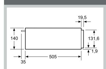
Über eine Wärmeschublade können Kompakt-Backöfen mit einer Gerätehöhe von 455 mm eingebaut werden. Ein Zwischenboden ist nicht erforderlich.
