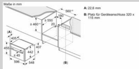
Wird das Kompaktgerät unter einem Kochfeld eingebaut, muss folgende Arbeitsplattenstärke (ggf. inkl. Unterkonstruktion) beachtet werden.
