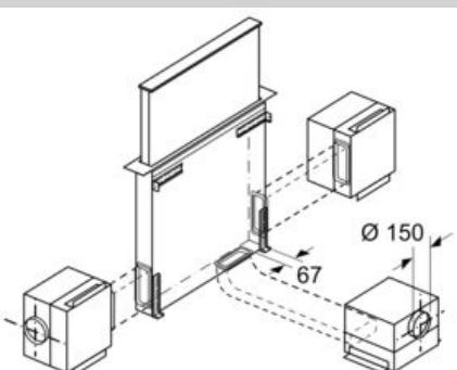
Motoreinheit kann mit maximal 3 m
