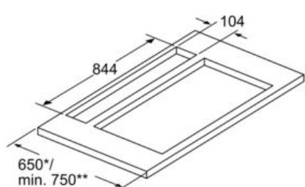
Gerät nur einseitig mit einem Abstand von min. 50 mm neben einem Hochschrank oder einer Wand installieren
