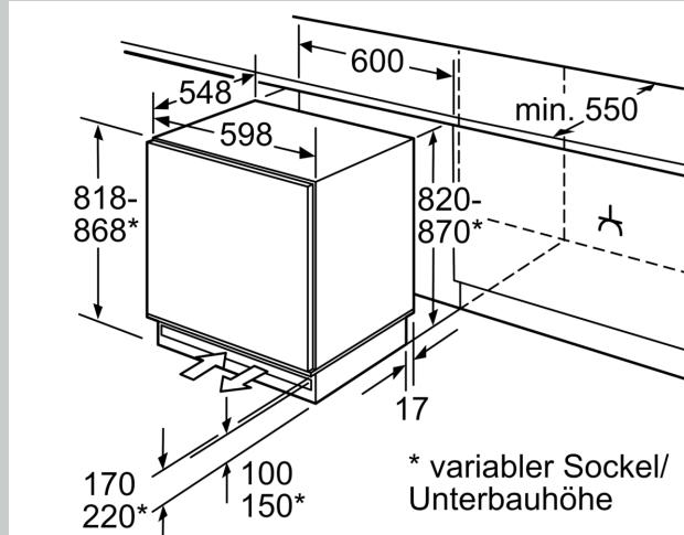
Platz für elektrischen Anschluß seitlich rechts oder links neben dem Gerät.
