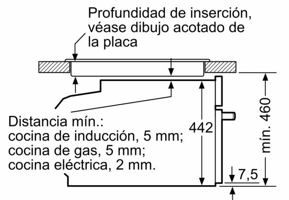
Si se instala el aparato compacto debajo de una placa, se debe respetar el siguiente grosor de encimera (incl., dado el caso, la estructura de soporte).
