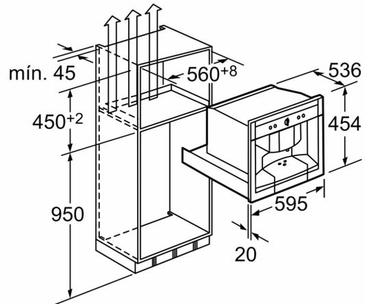
Una altura de montaje >950 mm dificulta el llenado de los recipientes para granos de café y agua colocados en el lado superior. Dimensiones en mm
