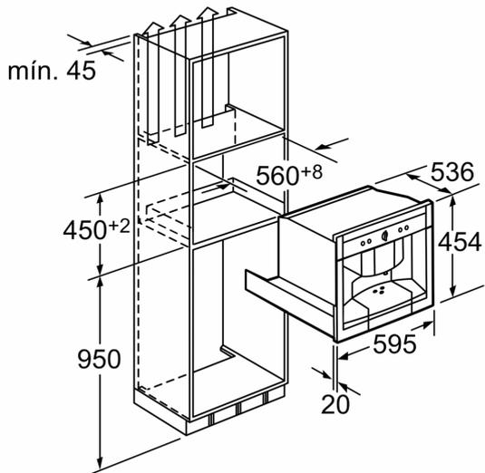
Una altura de montaje >950 mm dificulta el llenado de los recipientes para granos de café y agua colocados en el lado superior. Dimensiones en mm
