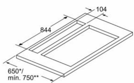
Instalar solo un lado del aparato junto a un
