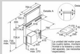
La unidad del motor puede girarse por los cuatro lados y montarse en la parte frontal o la trasera y colocarse a distancia del aparato. (se necesitan accesorios especiales)
