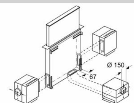
La unidad del motor se puede montar con una distancia máxima de 3 m al el aparato. (se necesitan accesorios especiales)
