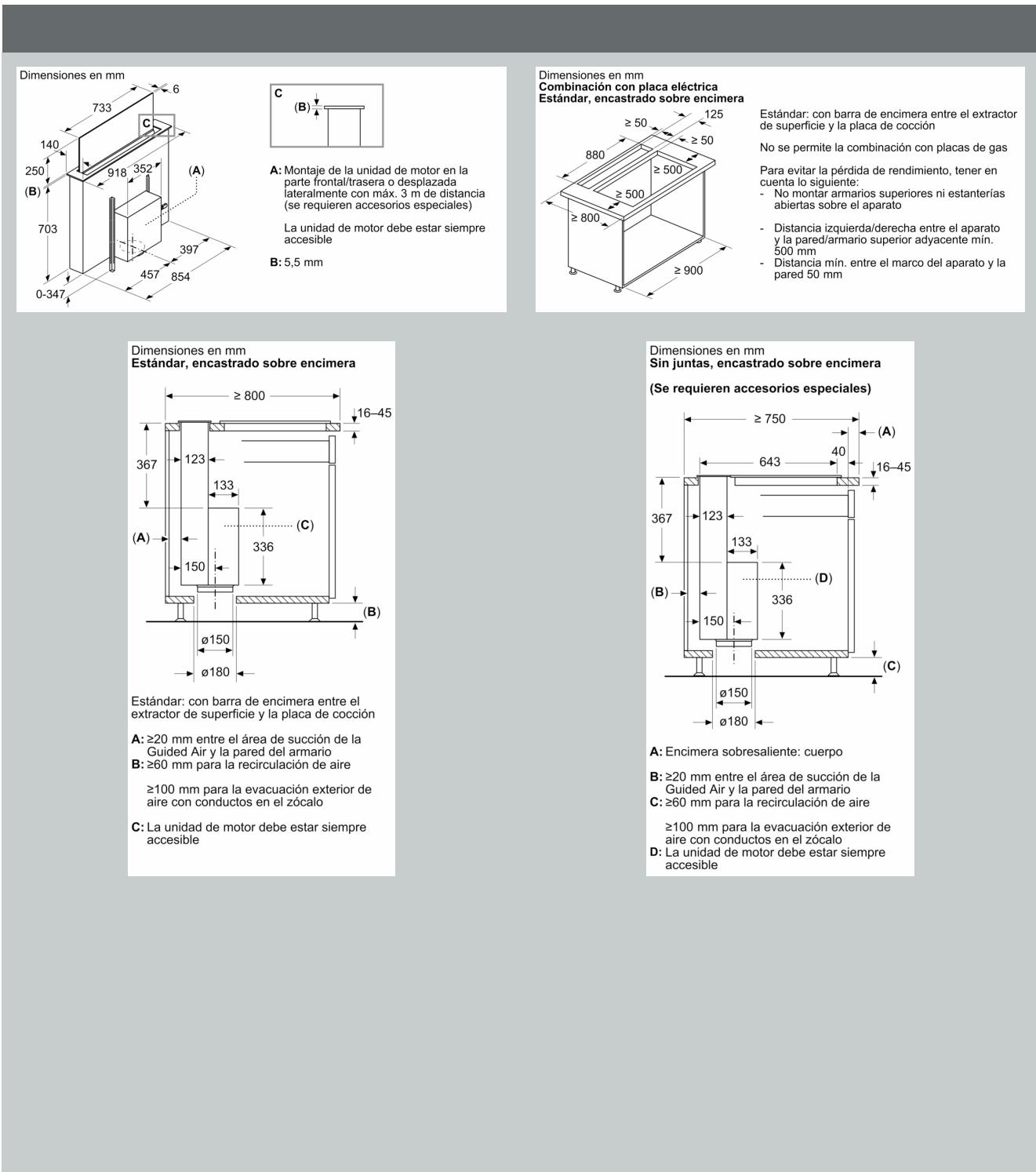
**Recomendaciones de planificación para funcionamiento con recirculación de aire**
