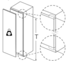
Las puertas del mueble montadas que exceden el peso permitido pueden provocar daños y deterioro funcional a la bisagra.
