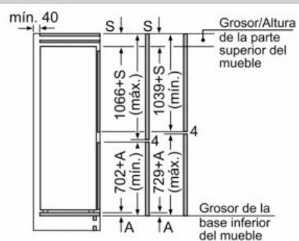
Las dimensiones dadas de la puerta del mueble corresponden a una junta de puerta de 4 mm.
