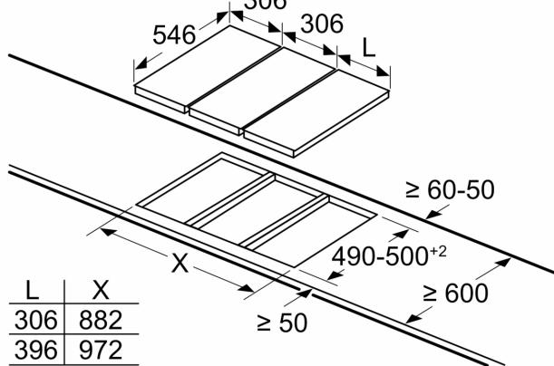
L'installation de deux unités Domino ou plus side-by-side requiert un kit d'installation ou plus (2 éléments = 1 kit d'installation ; 3 éléments = 2 kits d'installation, etc.).
