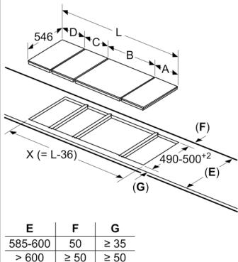
Lors de l'assemblage de plusieurs éléments côté à côté, plusieurs kits d'installation sont également nécessaires.
