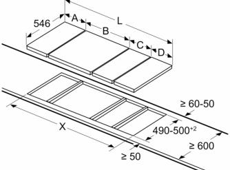
L'installation de deux éléments ou plus side-by-side requiert un kit d'installation ou plus (2 éléments = 1 kit d'installation ; 3 éléments = 2 kits d'installation, etc.).
