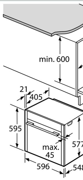
Si l'appareil est installé sur une table de cuisson, les épaisseurs de travail suivantes (le tout compris la sous-structure) doivent être respectées.
