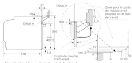
Si l'appareil est installé sous une table de cuisson, les épaisseurs de plaque de travail suivantes (le cas échéant y compris la sous-structure) doivent être respectées.
