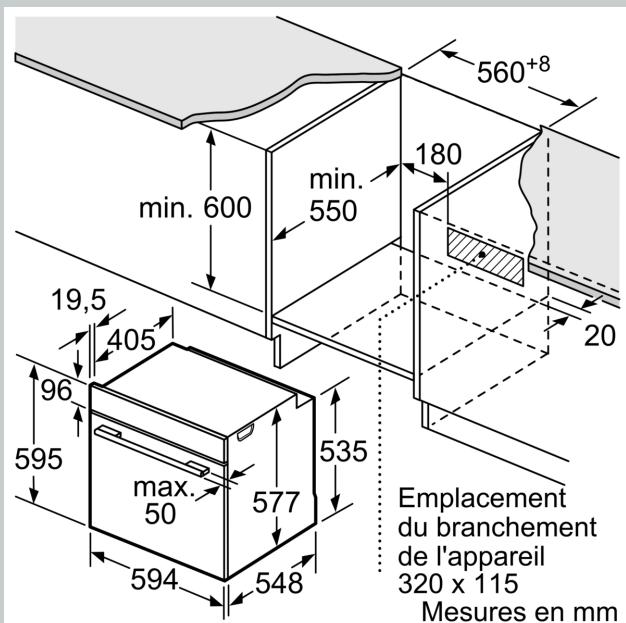
**Emplacement du branchement de l'appareil
