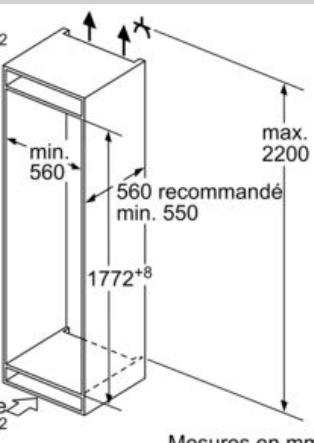
Ventilation dans le socle min. 200 cm<sup>2</sup>
