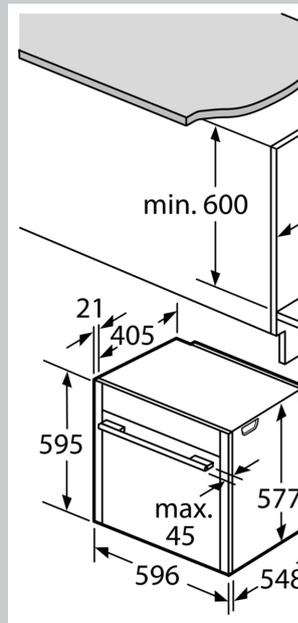
Si l'appareil est installé dans une table de cuisson, les épaisseurs de travail suivantes (le tout compris la sous-structure) doivent être respectées.
