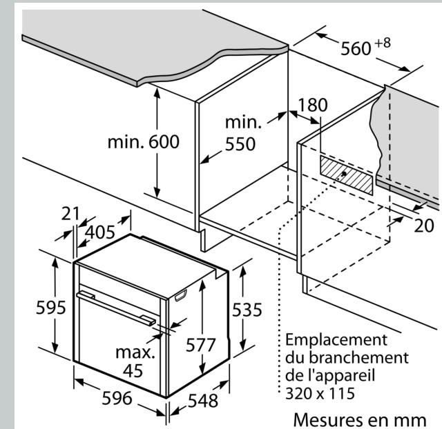
Si l'appareil est installé sous une table de cuisson, les épaisseurs de plaque de travail suivantes (le cas échéant y compris la sous-structure) doivent être respectées.
