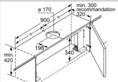
Le montage de la hotte tiroir de 90 cm dans un meuble haut de 90 cm de large requiert un kit de montage. Les deux angles de montage sont vissés à gauche et à droite dans le meuble. Montage selon gabarit.
