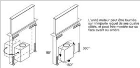
L'unité moteur peut être tournée sur n'importe lequel de ses quatre côtés, et peut être montée sur sa face avant ou arrière.
