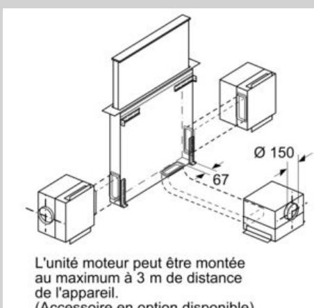
L'unité moteur peut être montée au maximum à 3 m de distance de l'appareil.
