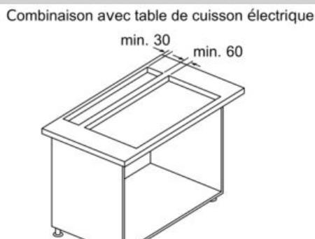
Pour une utilisation avec une table de cuisson à gaz, référez-vous au dessin « Combinaison avec table de cuisson à gaz ». Mesures en mm
