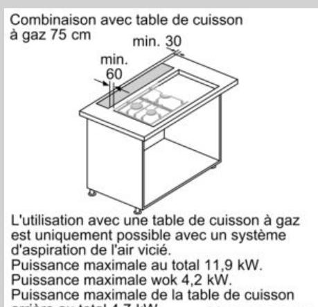
L'utilisation avec une table de cuisson à gaz est uniquement possible avec un système d'aspiration de l'air vicié.
