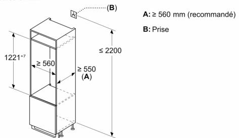
A:  $\geq 560 \text{ mm}$  (recommandé)
