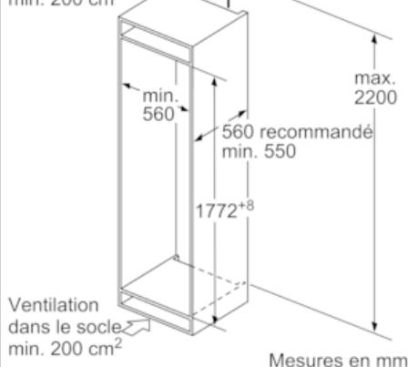
Ventilation dans le socle min. 200 cm<sup>2</sup>
