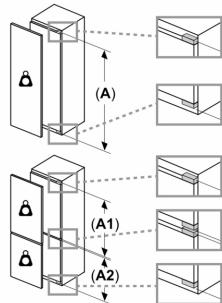
Poids maximal admissible des façades de l'appareil
