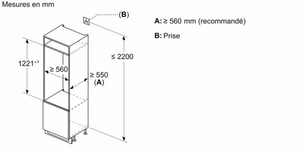
A:  $\geq 560 \text{ mm}$  (recommandé)
