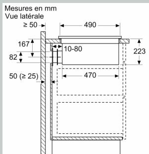
En cas d'installation directement contre des murs extérieurs qui ne sont pas isolés ( $\mu \geq 0,5 \text{ W/m}^2 \text{ °C}$ ), nous recommandons d'utiliser des configurations de recyclage partiellement ou totalement gainées.
