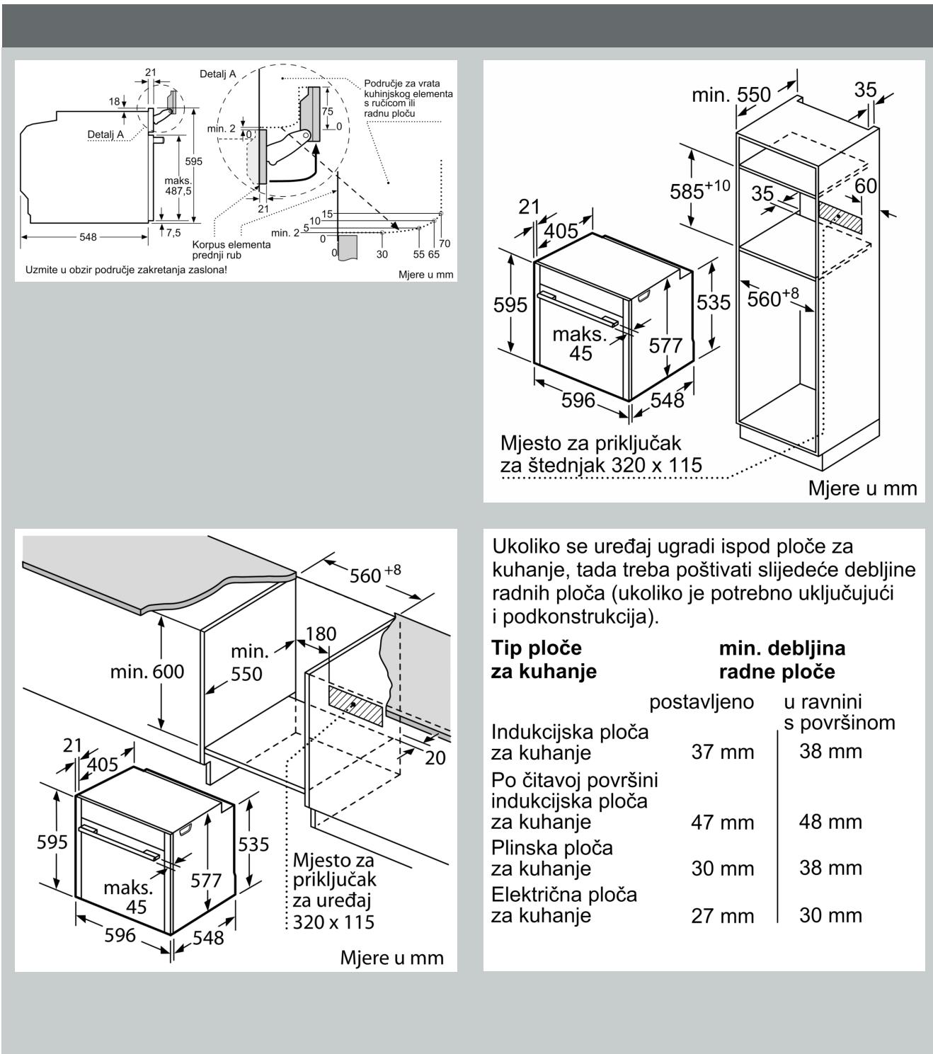
Ukoliko se uređaj ugradi ispod ploče za kuhanje, tada treba poštivati slijedeće debljine radnih ploča (ukoliko je potrebno uključujući i podkonstrukciju).
