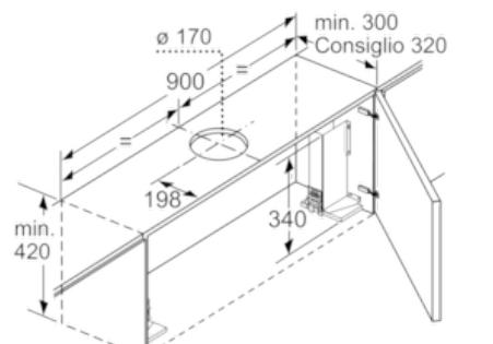
Per il montaggio della cappa piatta da 90 cm in un pensile da 90 cm è necessario un set di montaggio. Entrambi gli angolari di montaggio vengono avvitati a sinistra e a destra nel mobile. Montaggio in base alla mascherina.
