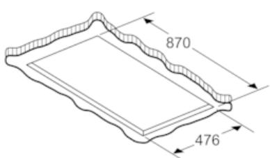
Per il fissaggio della cappa aspirante è necessaria un'adeguata sottostruttura portante. Non montare l'apparecchio direttamente in pannelli di cartongesso o materiali da costruzione leggeri simili.
