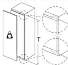
Le ante del mobile montate che superano il peso consentito possono causare danni e anomalie di funzionamento alla cerniera.
