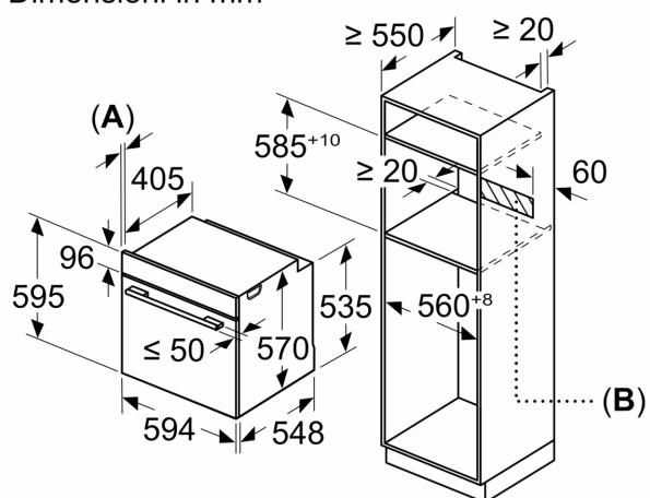
Montaggio con un piano di cottura.
