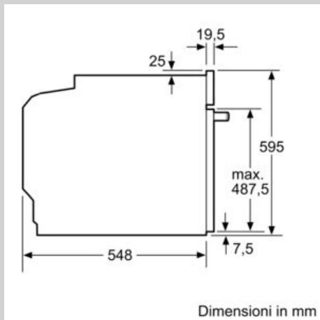
Montaggio con un piano di cottura.
