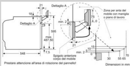
Se l'apparecchio viene montato sotto un piano di cottura deve essere rispettato il seguente spessore del piano di lavoro (event. incl. sottostruutura).
