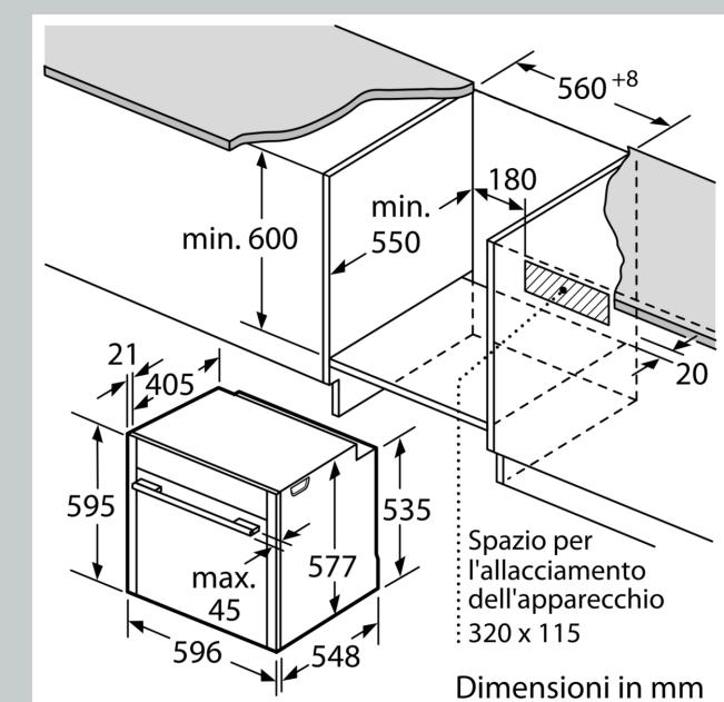
Se l'apparecchio viene montato sotto un piano di cottura deve essere rispettato il seguente spessore del piano di lavoro (event. incl. sottostruttura).
