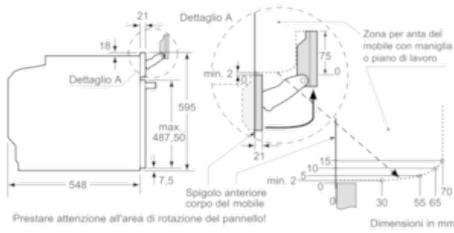
Se l'apparecchio viene montato sotto un piano di cottura deve essere rispettato il seguente spessore del piano di lavoro (event. incl. sottostruttura).
