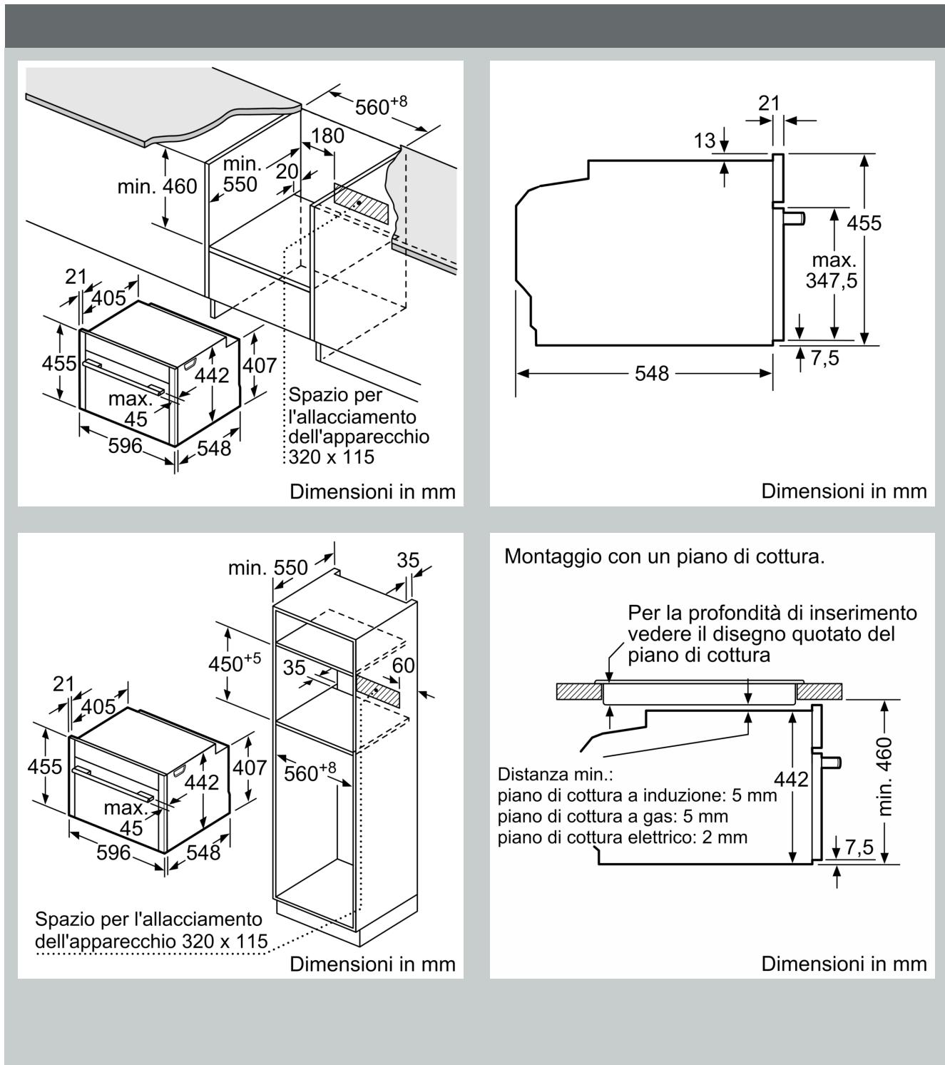
Se l'apparecchio compatto viene montato sotto un piano di cottura deve essere rispettato il seguente spessore del piano di lavoro (event. incl. sottostruttura).
