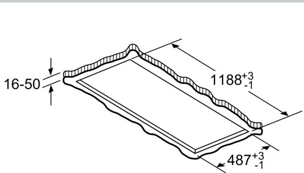
Non montare direttamente nel pannello di cartongesso o in materiali da costruzione leggeri simili del controsoffitto. È necessaria un'adeguata sottostruttura che sia fissata saldamente nella copertura in calcestruzzo.
