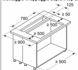
Standard: con alloggiamento del piano di lavoro tra ventola da piano e piano cottura
