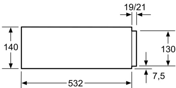
Sopra uno scaldavivande possono essere installati forni compatti con un'altezza apparecchio di 455 mm. Non è necessario un ripiano intermedio.
