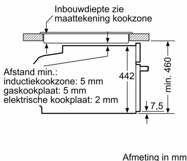
Wordt het compacte apparaat onder een kookzone ingebouwd, dan moet rekening gehouden worden met de volgende werkbladdikte (eventueel incl. onderconstructie).
