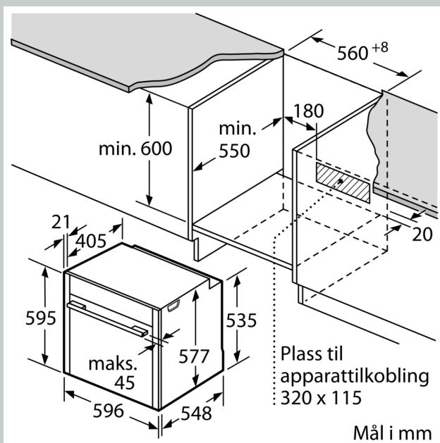
Dersom apparatet monteres under en platetopp, må benkeplatetykkelsen (ev. inkl. underkonstruksjon) være som følger.
