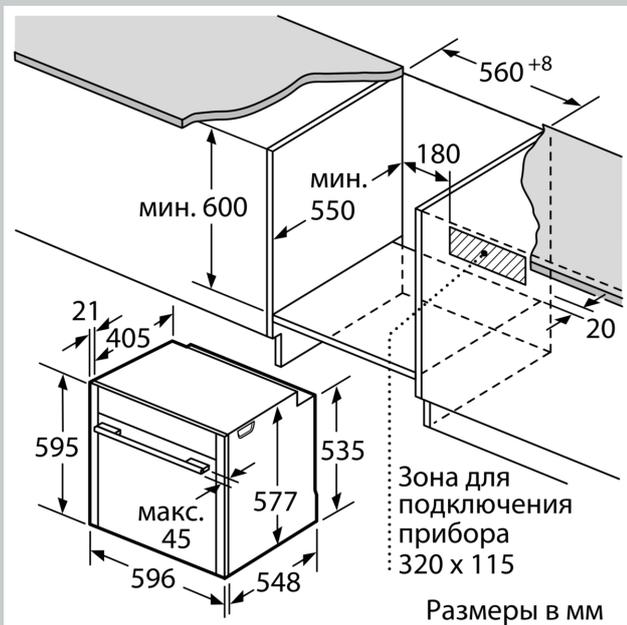
При встраивании прибора под варочную панель необходимо учитывать требования к толщине столешницы (включая усиливающий элемент).
